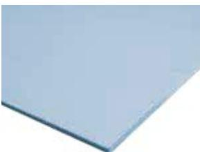
Glasroc H je gips-vlaknasta ploča vlagoupojnosti H1 idealna za izradu visokokvalitetnih zidnih i stropnih konstrukcija u vlažnim prostorima. Vodootporna ploča (GM-FH1) visoke otpornosti na vlagu i plijesan te podnosi do 90% kondenzacije.
