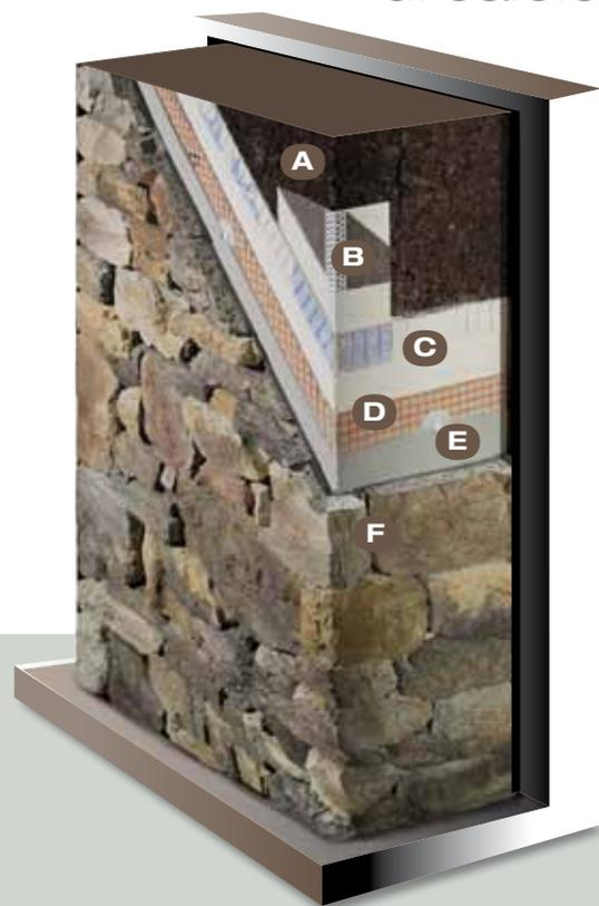
**A.** Pannello isolante in sughero incollato con collante A 96, metodo a cordolo perimetrale e strisce, oppure a totale superficie
