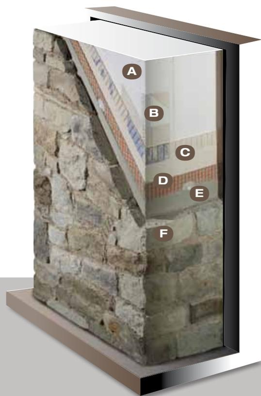
**A.** Pannello isolante in EPS incollato con collante A 96, metodo a cordolo perimetrale e strisce, oppure a totale superficie
