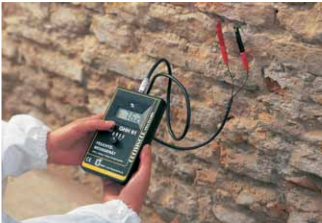
Mjerenje razine vlage higrometrom
